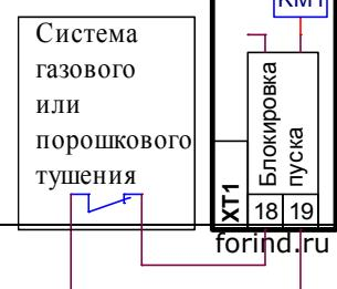
На рис. справа показан пример схемы блокировки шкафа управления вентилятора противодымной вентиляции при включении системы порошкового или газового тушения.
