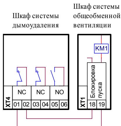
На рис. справа показан пример схемы отключения всех систем общеобменной вентиляции при включении вентилятора противодымной вентиляции.
